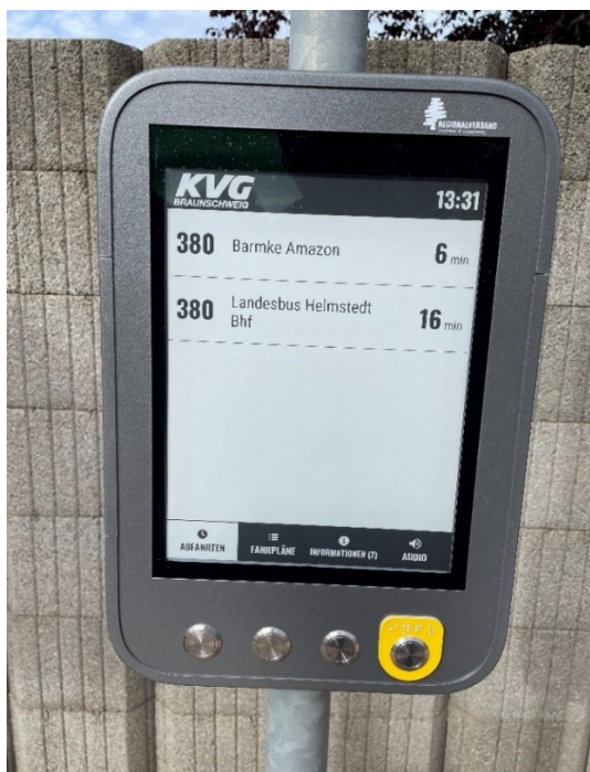
Abbildung 1.1: DIFA -Gerät an vorhandenem Mast (Bsp. Mariental)
