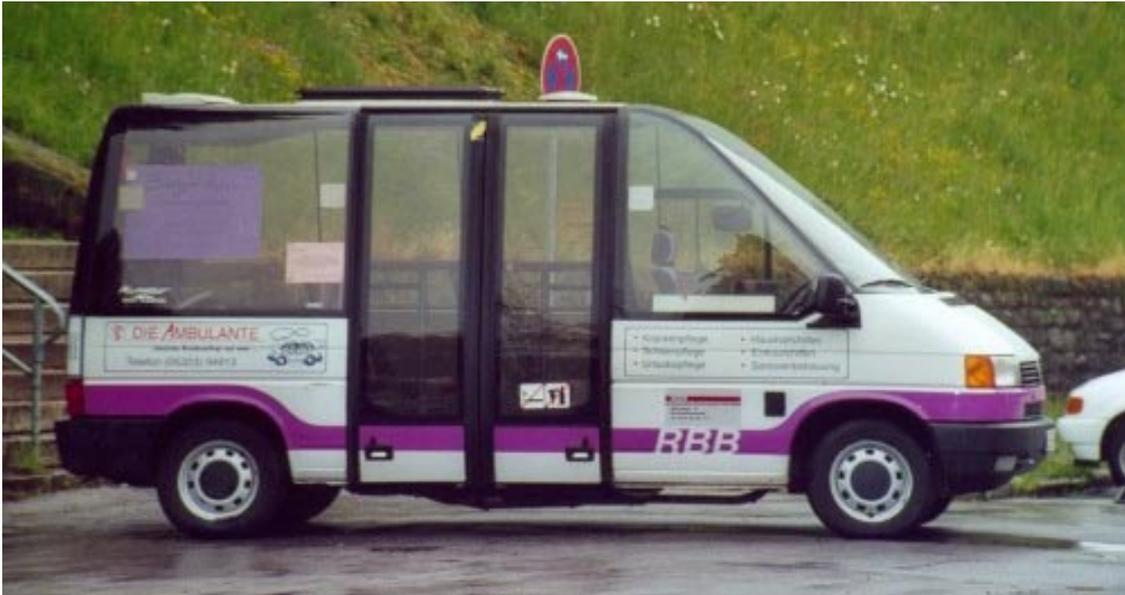
Abb. 2.4-4: Umgebauter VW T 4 mit Hochdach, Niederflur und elektrischer Tür vom Bürgerbus Oberharz
